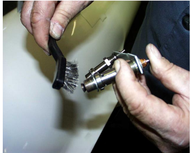
Bild 2: Reinigung der Dekompressions- ventile
